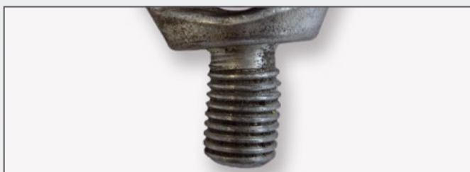
Odształcenie trzpienia gwintowanego
