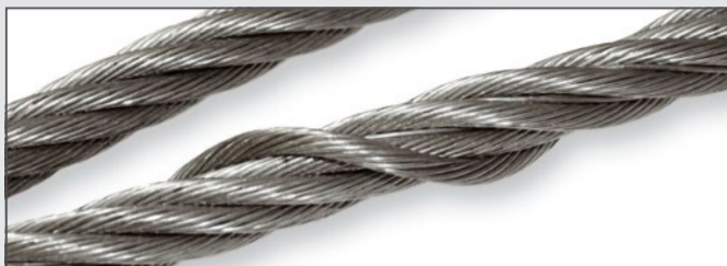
Poluzowanie warstwy zewnętrznej splotu
