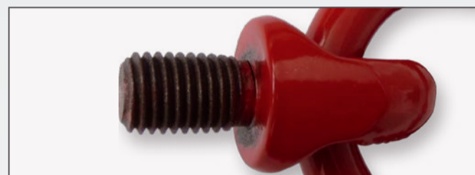
Pęknięcie na pierścieniu
