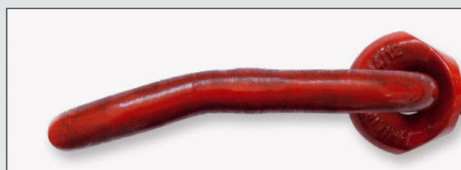
Skręcone ogniwo łańcuchowe
