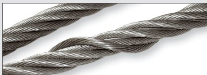
Poluzowanie warstwy zewnętrznej splotu
