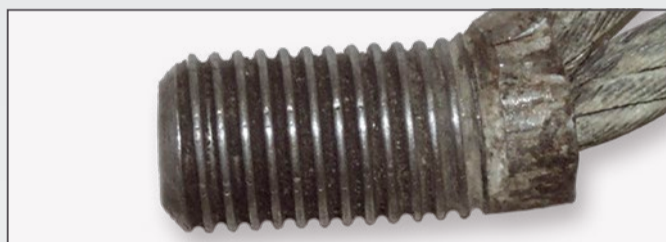
Uszkodzona część gwintowana
