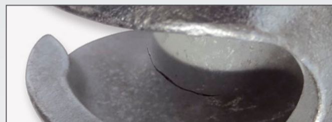
Pęknięcie w głowicy
