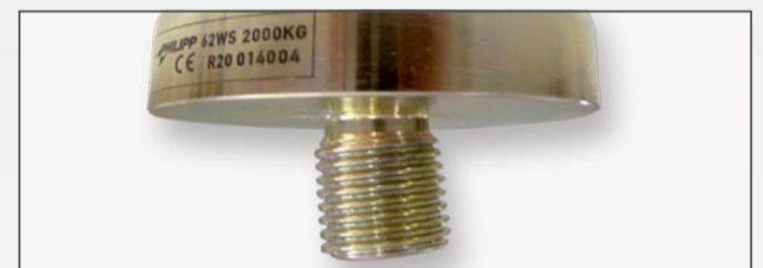
Odształcenie trzpienia gwintowanego
