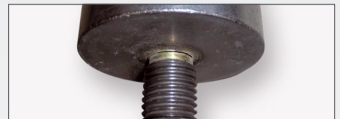
Pęknięcie na trzpieniu gwintowanym
