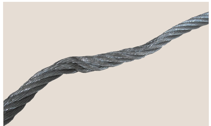
Die Ablegereife ist erreicht: Quetschung des Seils
