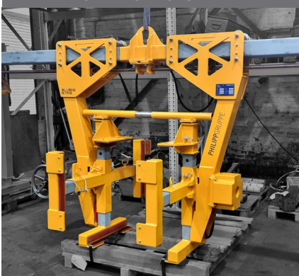
WENDEN VON BETONMODULEN
